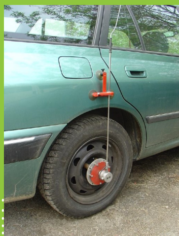
Roue de test Peiseler en place / Montiertes Peiseler-Messrad. Source / Quelle: Ing.-Büro Lohmeyer, Karlsruhe 2019
