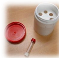
Tube passif pour le prélèvement du NO 2
