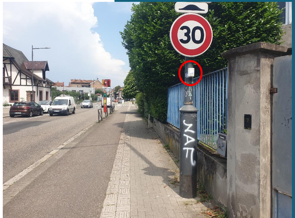
Tube passif route de Bischwiller (Source : ATMO Grand Est)
