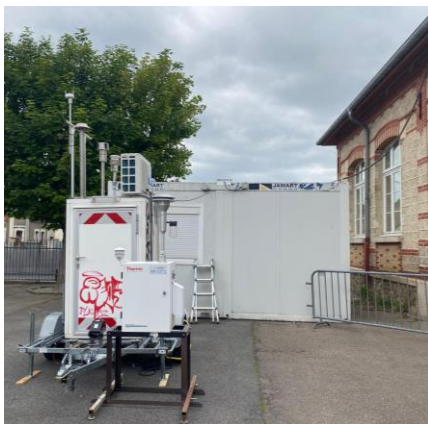
Cabine de mesure et préleveur Partisol pour les pesticides
